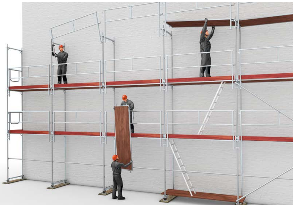
Beispiel für einen vorlaufenden, systemimmanenten oder -integrierten Seitenschutz
