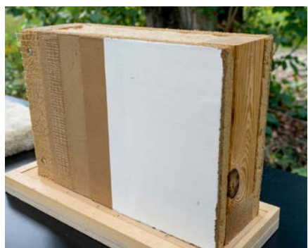
Musterwand für Trennwand aus Holz und Lehm
