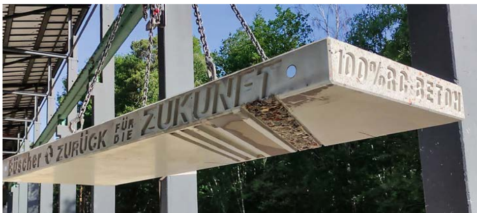
Eine RC-Betonplatte mit Label
