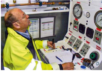
Beginn einer Druckkammerbehandlung: Steuerung des Druckverlaufs am Bedienstand der Druckkammeranlage
