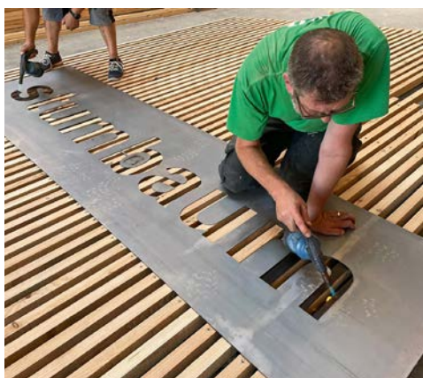
Beim Karbonisieren von Holz verbrennt man kontrolliert die oberste Schicht des Materials.
